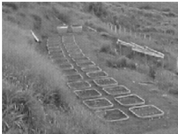
FIGURA 1. Vista dos lisímetros de percolação instalados no campo.
