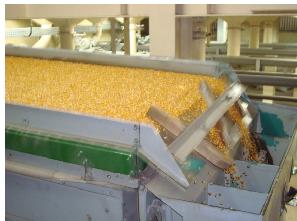
FIGURA 1. Mesa de gravidade aplicada a separação de diferentes densidades do produto.
