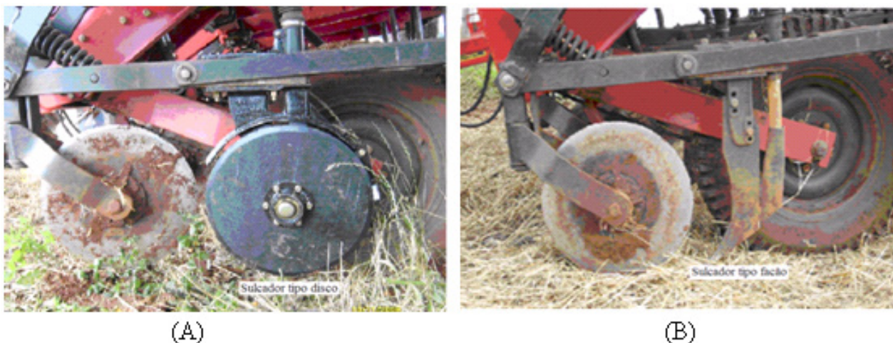
FIGURA 1. Sulcadores utilizados na condução do experimento: tipo disco duplo defasado (A) e tipo haste (B).
